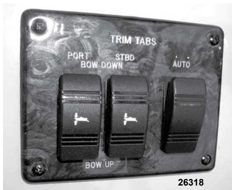
Interrupteurs typiques de commande manuelle et automatique des dérives
